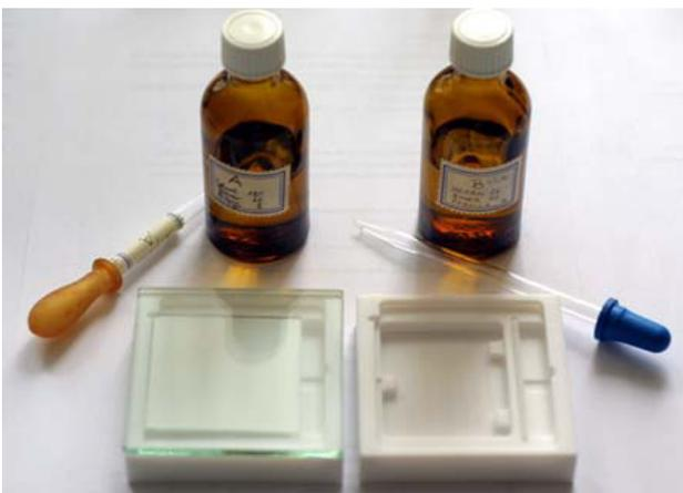
Abbildung 2: Trennkammern und Fläschchen, die die Laufmittel enthalten
